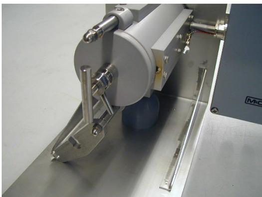
**Abbildung 7** Demontage des Filtergehäusedeckels
