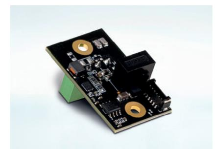
Pro Messkanal kann jeweils durch eine Zusatzkarte ein galvanisch getrennter Analogausgang mit 0-20/4-20 mA realisiert werden. Zusätzlich kann ebenfalls pro Messkanal eine Relaiskarte mit vier Digitalausgängen verbaut werden. Zwei der Digitalausgänge geben eine Rückmeldung über den eingestellten Messbereich, mithilfe der beiden anderen Ausgänge werden Grenzwertüberschreitungen übermittelt. Zur Anbindung externer Sensoren kann der Analysator zudem mit einer CAN-Schnittstelle bestückt werden.
